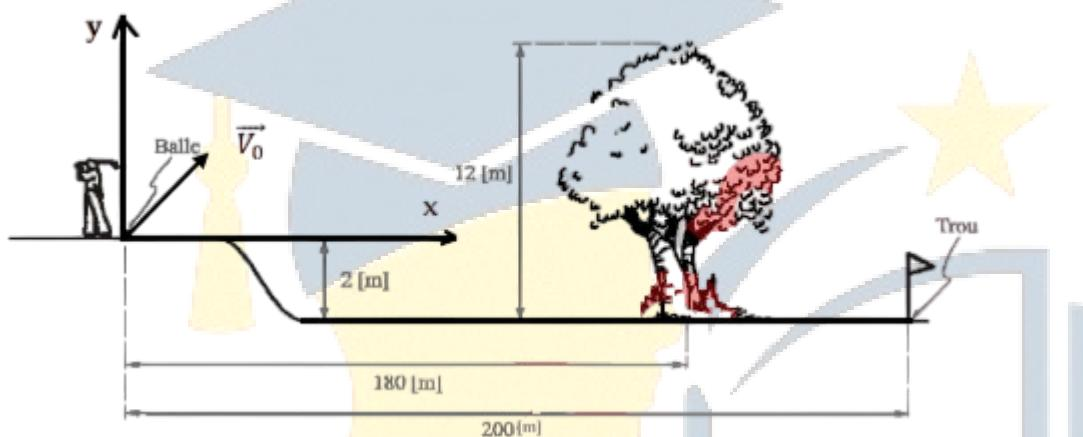
Déterminez l'amplitude  $V_0$  et l'angle  $\theta_0$  de la vitesse initiale que le joueur doit communiquer à la balle s'il désire que celle-ci frôle la cime des arbres et tombe directement dans le trou (sans rouler)
